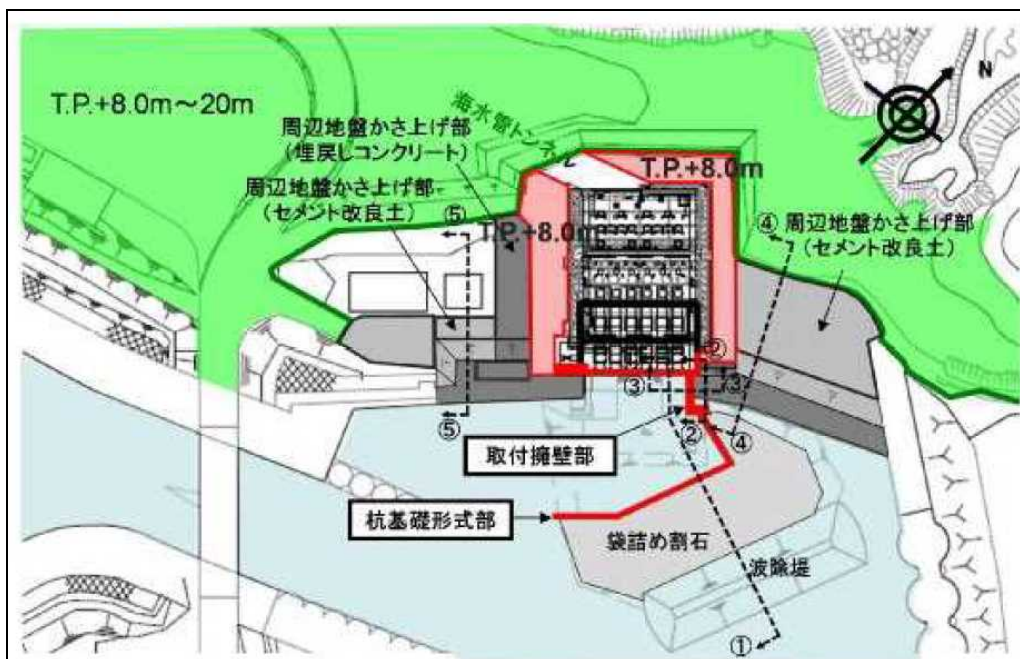
図 7.16 貯水堰平面図 (関西電力 大飯 3, 4 号炉)
