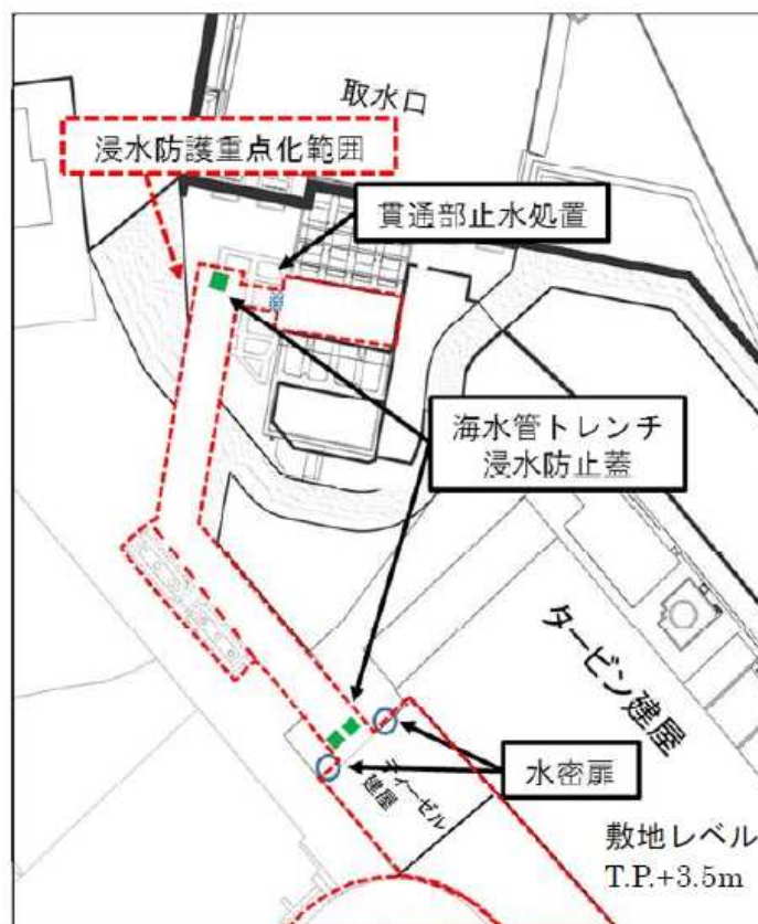
図 6.8 浸水対策設置箇所 (屋外 T.P.+3.5 m の範囲) (関西電力 美浜 3 号炉)
